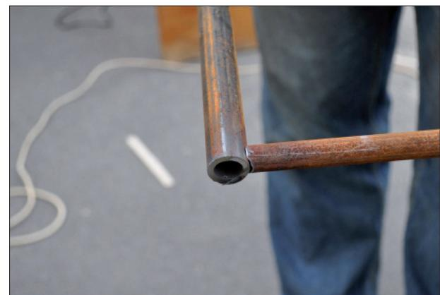
**Крок 6.** Приваріть 8 труб  $\frac{1}{2}''$  до двох труб  $\frac{3}{4}''$ , попередньо вирізвавши кінці труб  $\frac{1}{2}''$  так, щоб вони найщільніше прилягали до отворів в трубах  $\frac{3}{4}''$  (див. зображення) і закрійте кожну з двох труб  $\frac{3}{4}''$  з однієї сторони металевою заглушкою. Залийте в труби отриманої решітки воду, щоб упевнитися, що вона ніде не протікає.
