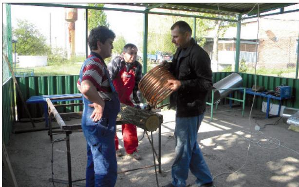
**Крок 1.** Виготовте теплообмінник. Діаметр спіралі повинен бути не набагато менший за діаметр бака. При згинанні спіралі треба прослідкувати, щоб труба теплообмінника не мала заломів і рідина могла вільно циркулювати.
