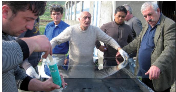
**Крок 12.** По краю скла встановіть гумовий П-подібний ущільнювач. Накрийте раму склом товщиною 4 мм, прикріпивши його по периметру рами. Акуратно притисніть і прикрутіть алюмінієвий монтажний кутник для кріплення скла до рами. Стик двох частин скла слід промазати силіконом, якщо воно складено з двох половин.
