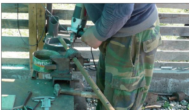
**Крок 5.** Просвердліть по 8 отворів діаметром 12-14 мм в двох  $\frac{3}{4}$ " металевих трубах на рівній відстані в 12,5 см одна від одної (див. схему на стор. 19)
